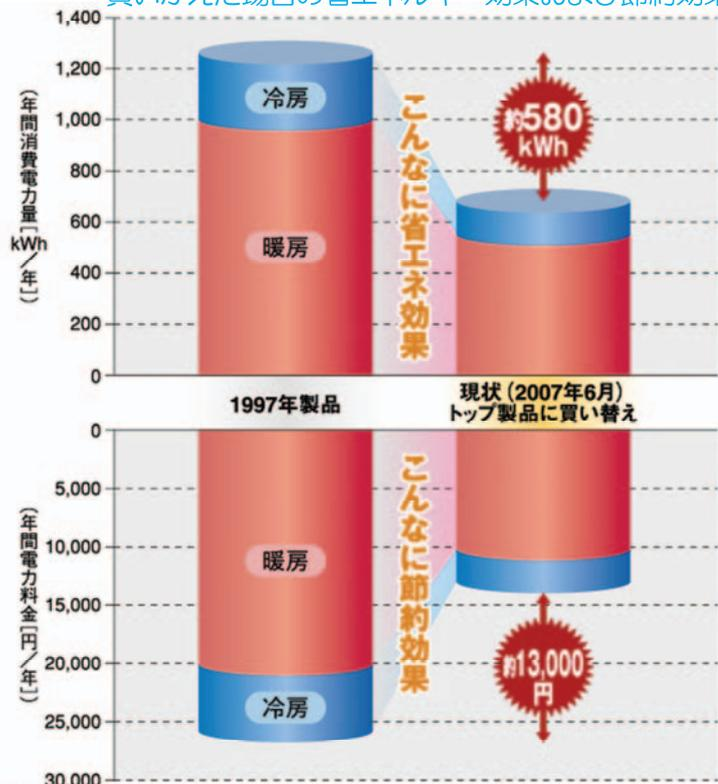
条件: 戸建住宅 (N地域、平成4年省エネルギー基準相当の断熱性能) のリビング (12畳相当) におけるエアコン (間欠運転) を想定し、冷暖房負荷を熱負荷計算ソフトウェアSMASHにて算定。1997年製品効率(1997年の冷房能力2.8kWクラスの平均定格COP、2007年6月時点トップ製品は2007年の冷房能力2.8kWクラスのトップ製品の定格COPから、それぞれ実稼働効率を考慮し、算定。
