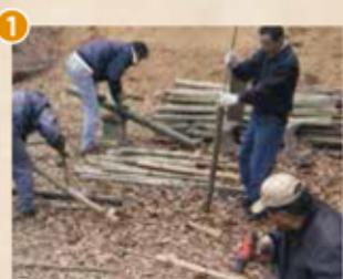
竹を伐採して下準備。1mの長さに切って、節に穴をあけ、2～3ヶ月乾燥させる。
